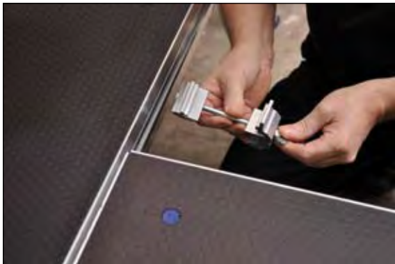
Sicherung mit 2 Podest-Verbindern pro Meter
