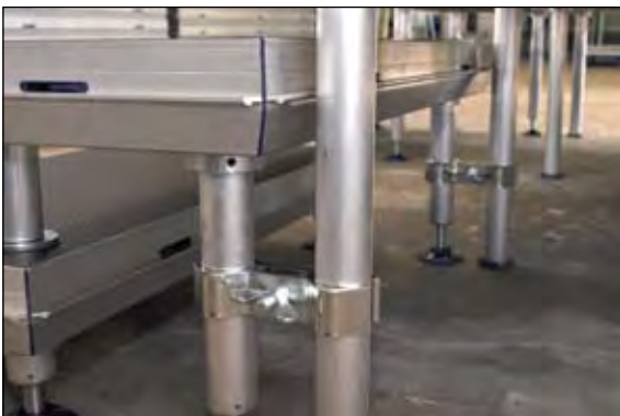
Verbindung Federseite: 2 Fuß-Verbinder 110 mm
