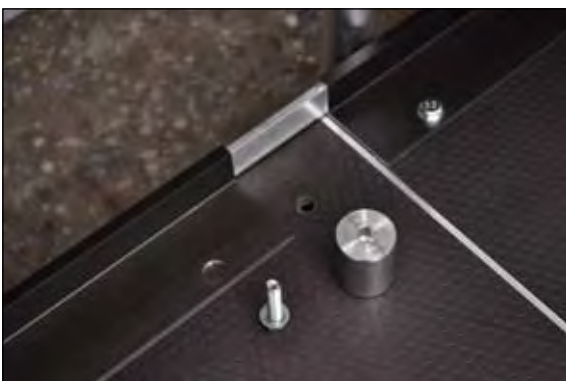
Stoßboard anschrauben Verbindungsstück einschieben evtl. Adapter einsetzen
