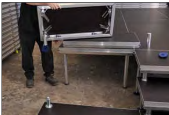
Erweiterungspodest: Füße und Aufnahmebolzen nur links
