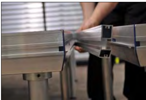
Anbringung Treppe an der Federseite
