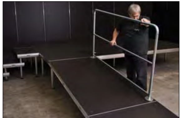
bei Bedarf Geländer einsetzen
