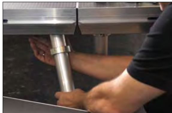
evtl. zusätzlichen Fuß einsetzen
