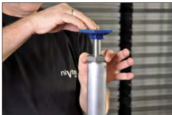
nivellieren Kontermutter festziehen
