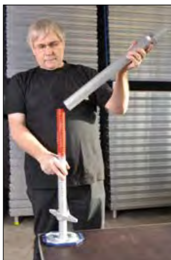
WechselfuÙ auf Spindel aufstecken
