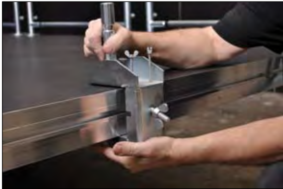
Geländer -Sonderaufnahmebolzen 26 mm
