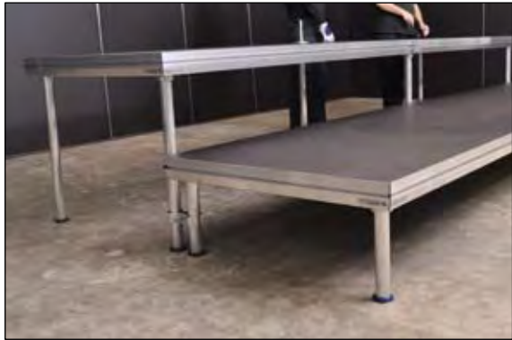
Reihen nach nivtec-Prinzip aufstellen Fußverbinder einbauen
