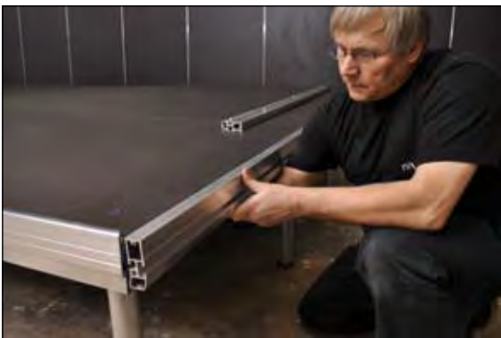
Federseiten: Adapterleiste aufsetzen und verriegeln
