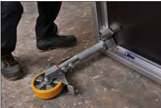
in Fußaufnahme einstecken und sichern
