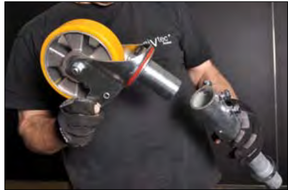
Rolle in Verlängerungsadapter einstecken und sichern
