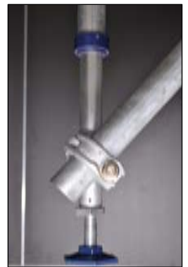
Sæt på teleskop- skopben nederst på inderrør
