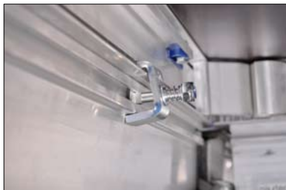
Sikkerhedslåsens funktion: At holde podier og underkonstruktion sammen
